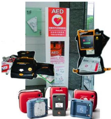
心室細動と呼ばれる不整脈(心臓のけいれん)によってポンプとして動かなくなってしまった心臓に、電気ショックを与えることにより、元の収縮(動き)を取り戻させるための機器です。AED は、心電図を自動的に解析し、音声や表示をしてくれます。落ち着いて AED の指示に従い救命処置を進めてください。
